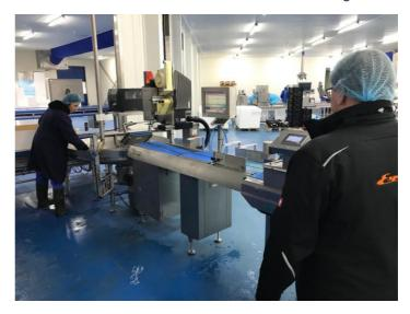
Beispiel ganze Lachsstücke bis 600mm, aber auch kleine portioniert Packungen verwogen und ausgezeichnet werden können. Alles mit nur einer Maschine. Das absenkbare Band kommt bei langen Packungen zum Einsatz und ist mit nur einem Handgriff einstellbar. Vergleichbare Lösungen am Markt gibt es nicht. Bei anderen Herstellern muss man auf eine separate Linie mit einem langen Wagenband zugreifen. Was deutlich höhere Kosten bedeutet.
